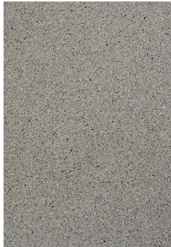
BETONoberfläche Grau gesäuert
